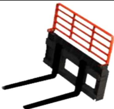
несъемная защита, грузоподъемность **1000** кг на 500 мм, длина клыков **1200** мм, ширина каретки 1260 мм, тип каретки 2А, максимальная ширина вил 985 мм, высота с защитой 1010 мм, ручная регулировка ширины, масса 157 кг
