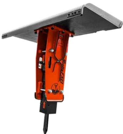
LO-2, энергия удара **360** Дж, диаметр пики 38 мм, частота ударов 600-1200 уд./мин., рабочее давление 100-110 атм, поток масла 10-16 л/мин., масса 70 кг
