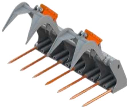
ширина **1700** мм, объем захвата при раскрытии 0,7 м<sup>3</sup>, максимальное раскрытие 960 мм, гидравлический двойной тип прижима, масса 300 кг
