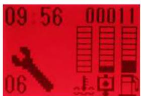
◀ В случае возникновения неисправности погрузчика, подсветка дисплея станет красной и отобразится соответствующая иконка неисправности, а ниже отобразиться код неисправности.
