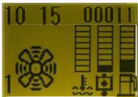
◀ При нажатии кнопки включения системы отопления на дисплее отображается соответствующая иконка отопления с цифрой, указывающей на режим работ системы отопления. Если включен режим системы отопления № 1 или № 2, иконка отображается в течение 10 секунд, если режим № 0 (отключено), иконка отображается в течение 5 секунд.
