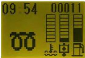
◀ Подогрев двигателя отображается следующим образом.
