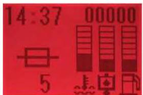
◀ Выключение предохранителя отобразится следующей иконкой с одновременной подсветкой дисплея красным цветом, при этом на дисплее отобразится номер предохранителя. Функции, относящиеся к этому предохранителю автоматически отключаются.
