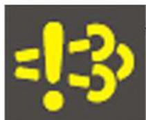
• контрольный неисправности выхлопной системы
