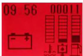
◀ Неисправность заряда аккумулятора отображается следующей иконкой и красной подсветкой дисплея.
