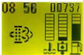
◀ Если при запуске двигателя датчик присутствия оператора неактивен, на дисплее отобразится иконка сиденья.
