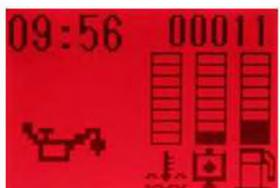
◀ Неисправность системы смазки отображается следующей иконкой и красной подсветкой дисплея.
