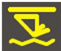
• контрольный индикатор плавающего режима
