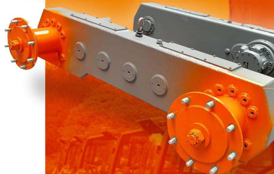
**ОСНОВНОЕ ОТЛИЧИЕ ЗАКЛЮЧАЕТСЯ В ИСПОЛЬЗОВАНИИ НЕ ДВУХ, А ОДНОЙ ЦЕПИ В КАЖДОМ БОРТУ, А ТАКЖЕ НАЛИЧИЮ ДОПОЛНИТЕЛЬНОЙ ШЕСТЕРНИ.** Таким образом передние колеса вращаются шестерней, а задние только цепью.
