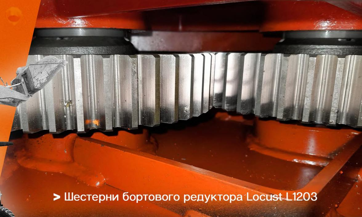
> Шестерни бортового редуктора Locust L1203
