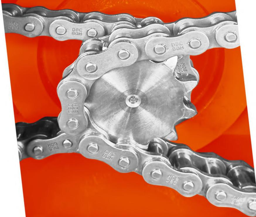
Стандартно для приведения в движение минипогрузчика с бортовым поворотом обычно используются два гидромотора хода – по одному с каждого борта. Передача вращения на колеса производится при помощи двух предварительно натянутых роликовых цепей со звездочками в герметичном картере цепной передачи. Такой тип передачи можно смело назвать цепным.
