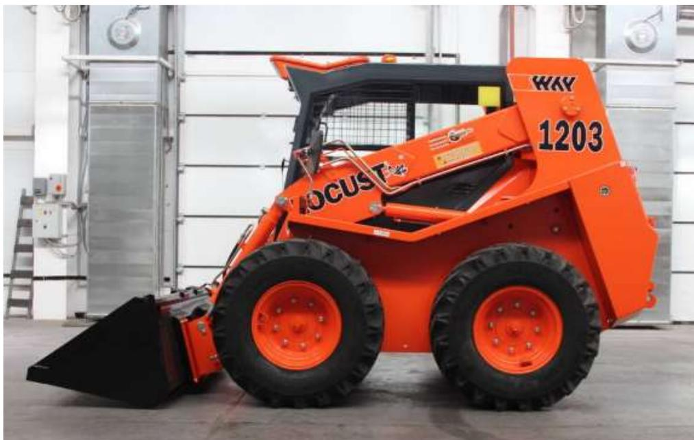
Новые Мини-погрузчики LOCUST L1203 Perkins предназначены для перевозки и погрузки строительных и других материалов. Максимальная грузоподъемность - 1000 кг. Эксплуатируется на строительных, складских и промышленных объектах.
